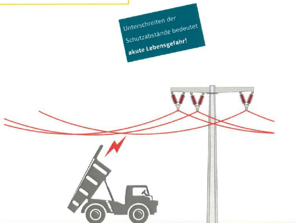
Abbildung 4: Berühren einer 20 kV-Leitung beim Entleeren eines LKW
